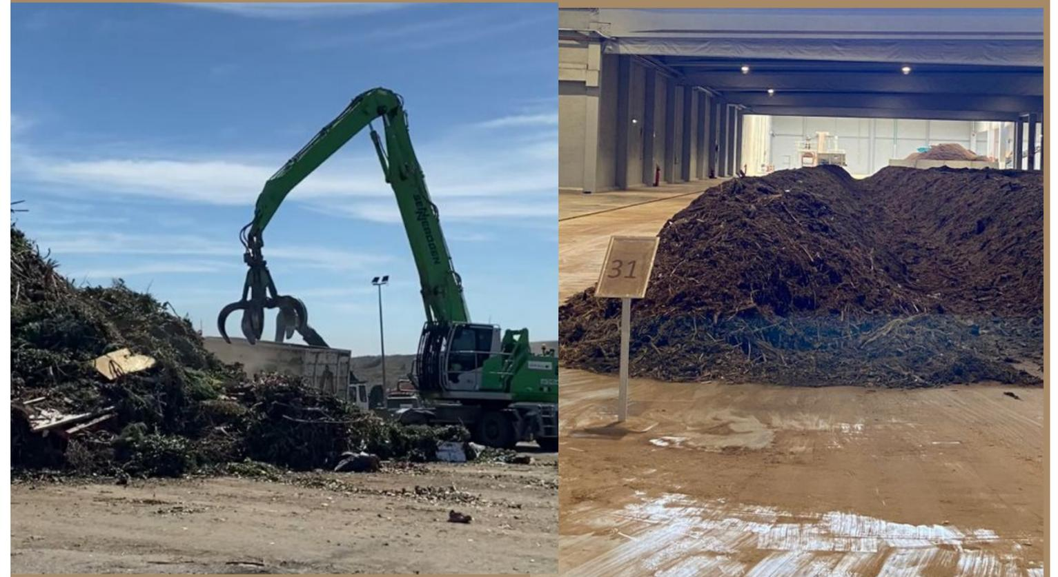
Galpão de compostagem de resíduos verdes com máquinas de revolvimento e umidificação. O processo leva cerca de 16 semanas. Após a compostagem, o material passa pela crivagem.
